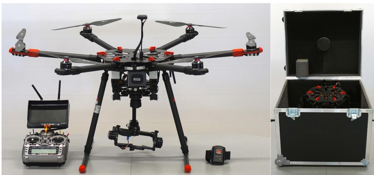
Figura 26 - Drone esacottero ESA960 di proprietà Ecogeo (ECOGEO 960)
